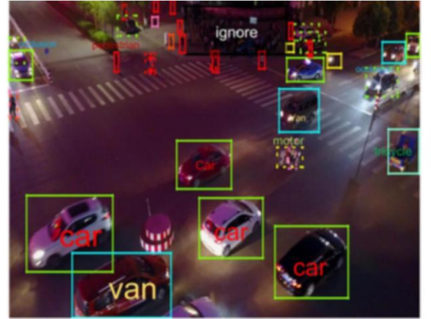
基于无人机视觉平台的目标识别 (YOLO算法)
